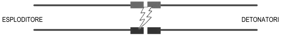
Figura 1. Collegamento ERRATO – Al momento della scarica la tensione elevata consente alla corrente di “saltare” da un polo all’altro della linea di tiro.
